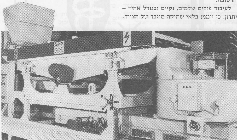
מתקן בישול בקרני תת־אדום: משקלו 7.6 טונות, וממדיו: אורך 7.4, רוחב 2, גובה 5.5. תפוקתו כ־2 טונות פולים בשעה.
