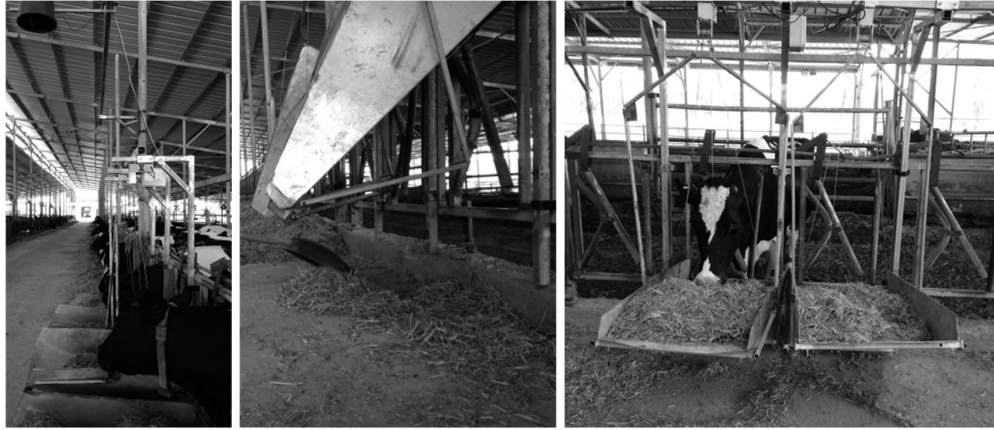
איור 1: משקלים תלולים ברפת: מבנה כללי (שמאל), מיכלים במצב מורם וניקוי שאריות מזון בעזרת כף או טרקטור, מצלמת זיהוי מותקנת מעל העמדות (ימין).
